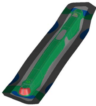
Figura 2a: Simulação OneStep do repuxo (Ruptura região em vermelho)
